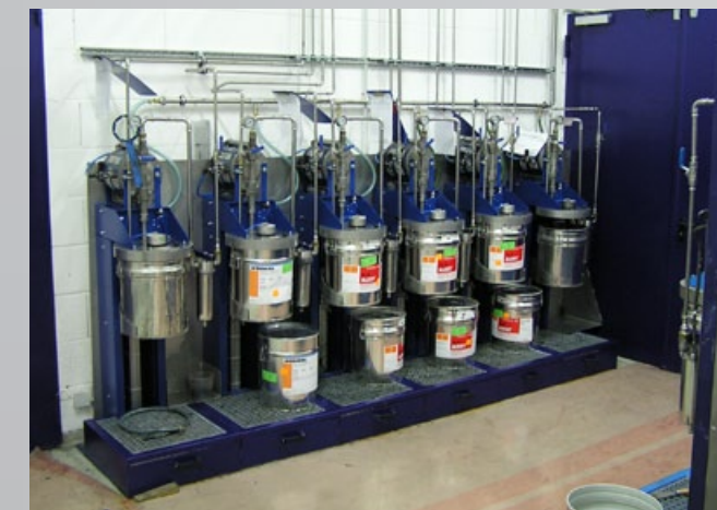
Farbversorgung aus Hobbock mit Auffangwanne Paint supply system with hobbock incl. collecting pan
