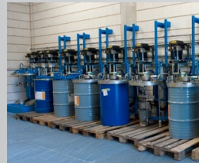
Containerfarbversorgung für Wasserlacke mit Wandhubgestell Container-paint supply for waterborne paint with wall lifting frames
